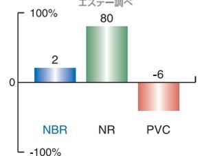
※NBR, NRは油を吸って膨潤、PVCは可塑剤溶出し収縮する。
